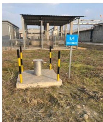
4#地下水检测井
