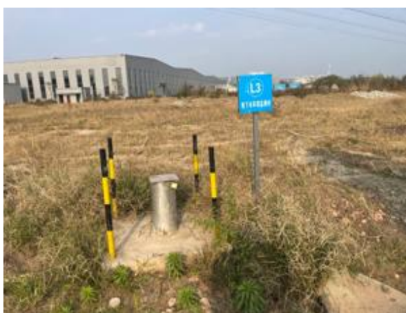
3#地下水检测井
